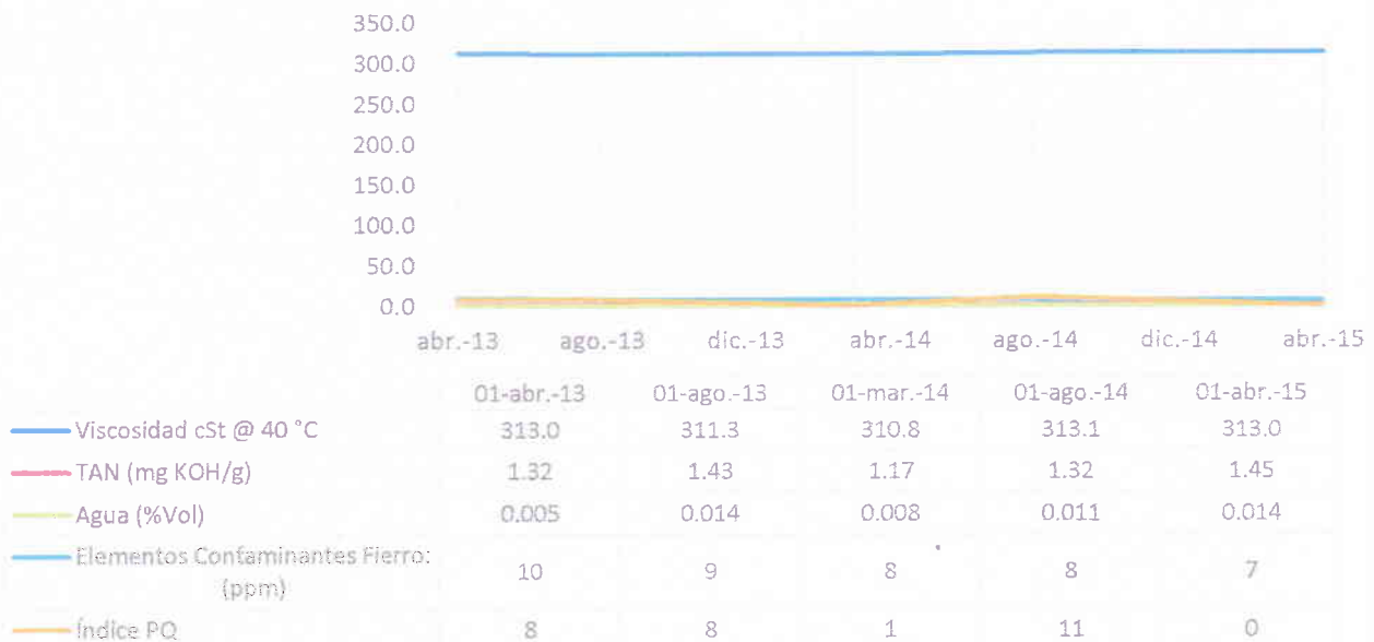
Imagen 4.- Reductor de la Tercera Prensa: En la imagen se muestra la tendencia y los valores obtenidos al monitorear el lubricante en este equipo, comprobándose que el lubricante ha dado y superado el desempeño esperado.
