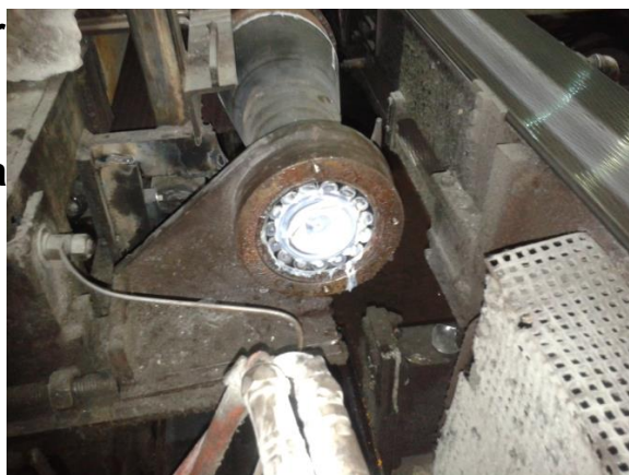
Chumacera Rodillo de entrada Templador 23
