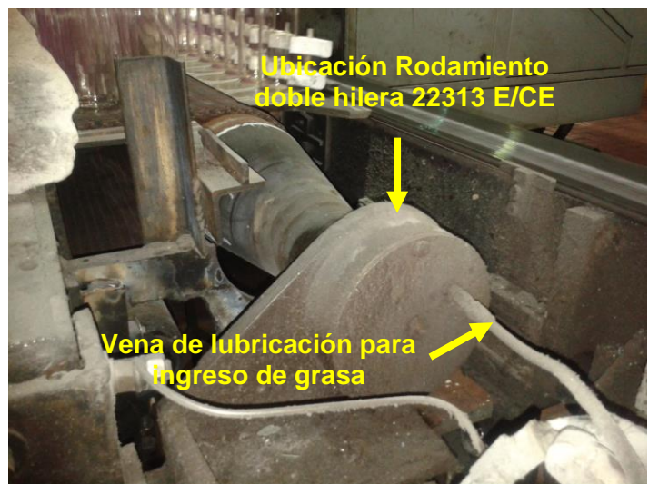
Imagen 1: muestra donde se encuentra el rodamiento del Templador
